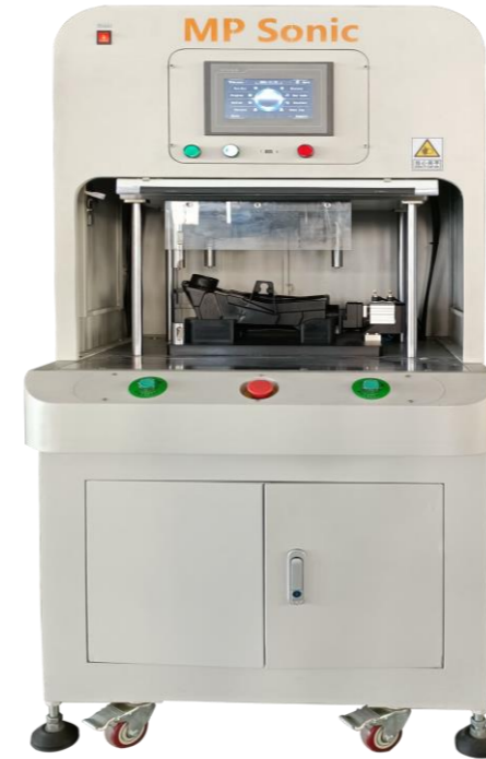
气密测试站 Airtight Test Station
